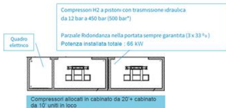
Figura 86. Configurazione tipica del container "compressione"(immagine esemplificativa)
